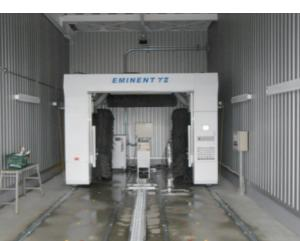
静音・節水タイプの門型洗車機
